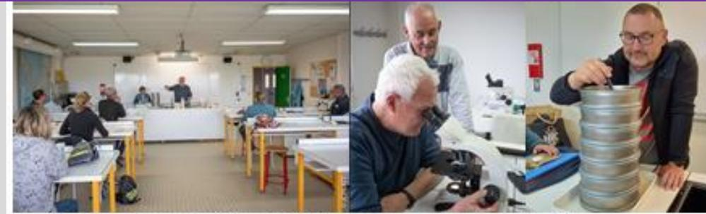
Le méiobenthos : techniques de prélèvement et de tri sur une succession de tamis de 0,63 µm à 2 mm
